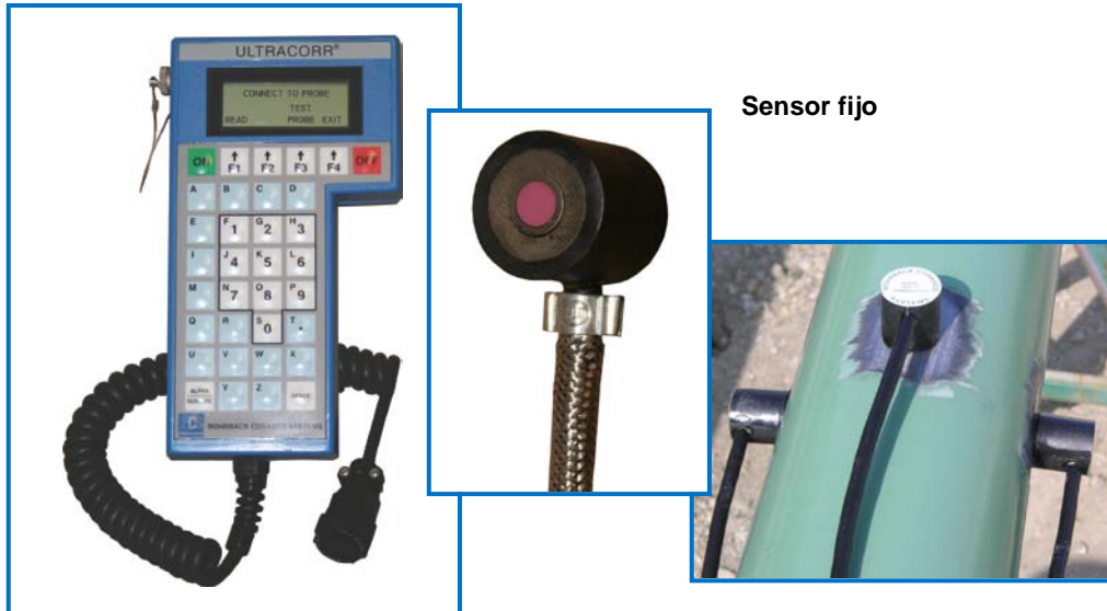
Transductores permanentemente conectados a la tubería antes de la instalación
