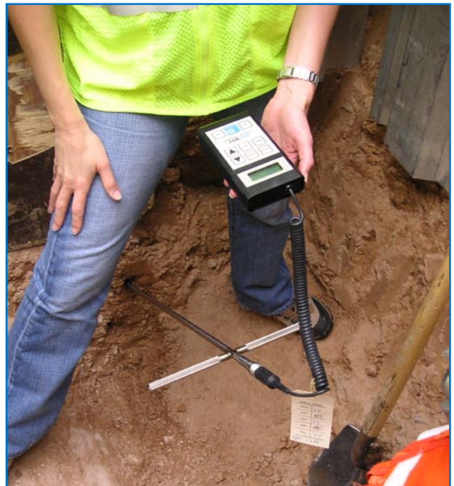
Medición directa de la tasa de corrosión con la sonda de medición de la tasa de corrosión
