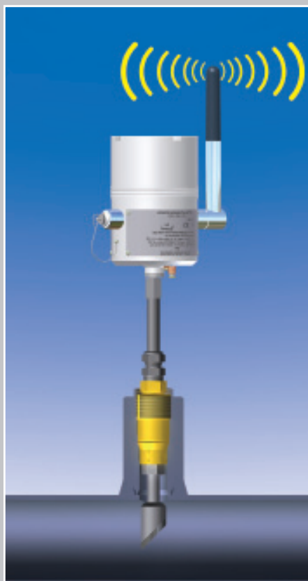
Установленный беспроводной передатчик Microcor® с переходником для датчика и датчиком Quicksand™ в фитинге доступа Cosasco®
